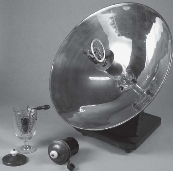
Modèle pédagogique de l'insolateur d'Augustin Mouchot et deux de ses accessoires conservés au lycée Guez-de-Balzac d'Angoulême. (Cl. Francis GIREs)
