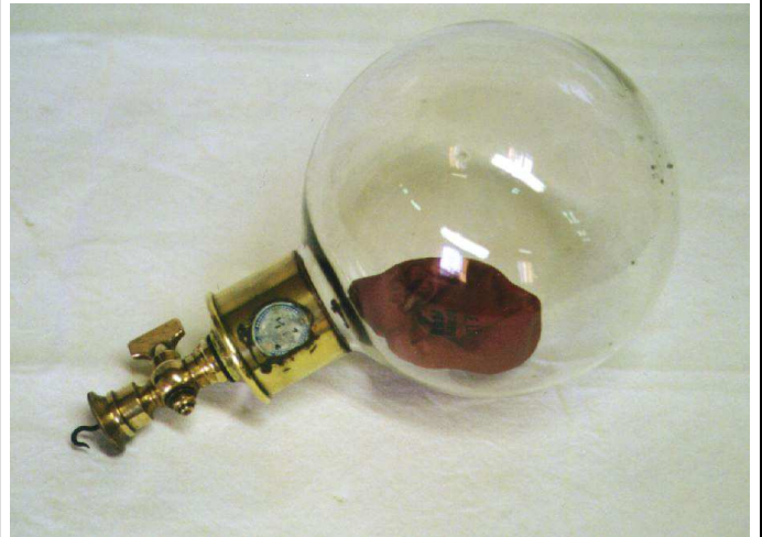
10. Ballon de baudruche dans une enceinte à relier à la pompe à vide (origine : lycée Brizeux, Quimper)
