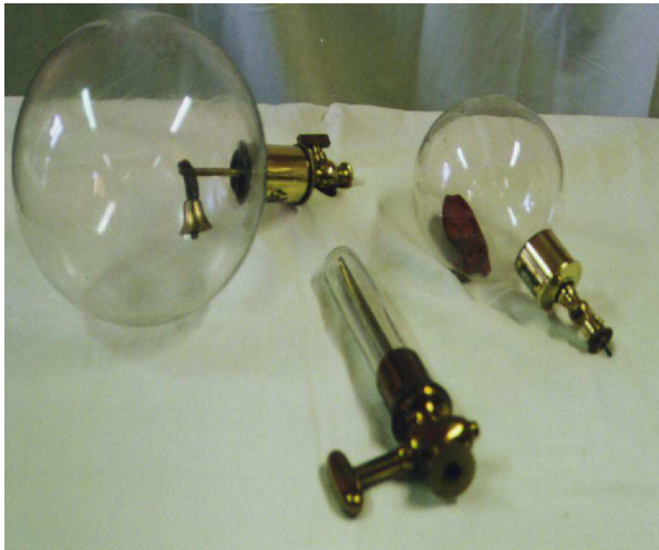
9. Clochette dans une enceinte à relier à la pompe à vide (origine : lycée Brizeux, Quimper)
